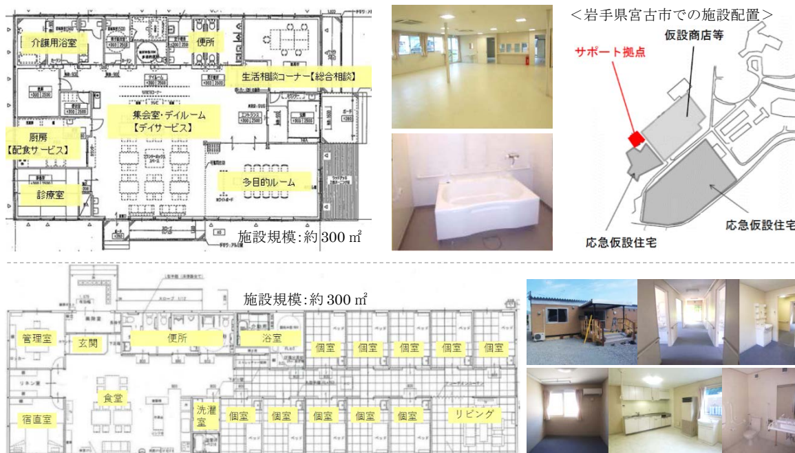
図1：岩手県のサポート拠点例（上）と福祉仮設住宅例（下）の平面図・写真等
